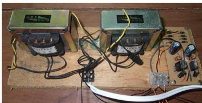
Figura 6.4: Foto da fonte simétrica e regulada de 15VCC
